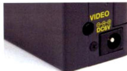
du cordon opte pour le standard européen. A savoir, le pôle positif au point chaud, donc au centre. A noter qu'existe aussi un large orifice marqué "SD". Dans ce dernier, il faudra insérer une carte "SD" (jusqu'à 4 GB) grâce à laquelle on bénéficiera d'une importante capacité de mémorisation des images vidéo captées par le récepteur. A titre indicatif, avec une carte d'1 GB on peut stocker environ 2000 images vidéo !
